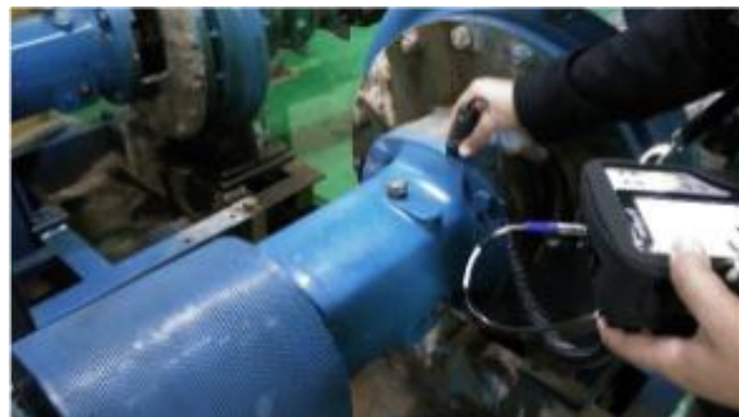
Gambar 16, Ilustrasi Pengukuran vibrasi pada Pompa
