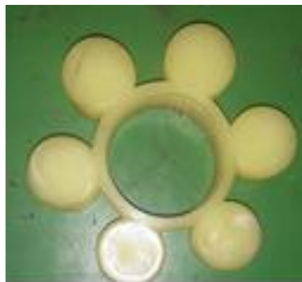
Gambar 11, Rubber coupling pada pompa air side seal oil PLTU Pelabuhanratu
