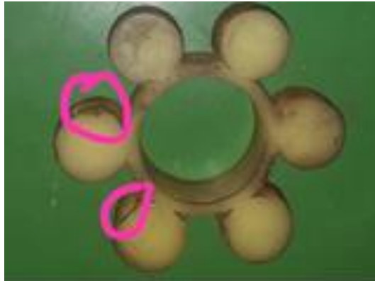
Gambar 12, Temuan surface rubber coupling aus
