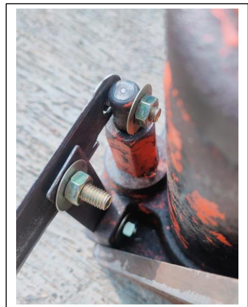
Gambar 9, Perakitan Batang Pendorong
