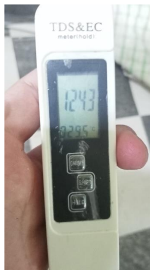
Gambar 44. pengujian keempat menggunakan TDS/EC meter
