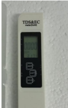
Gambar 36. pengujian TD S/EC meter pada awal penyalaan
