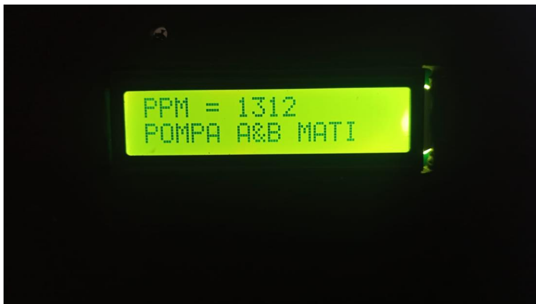
Gambar 47. pengujian kelima menggunakan EC sensor
