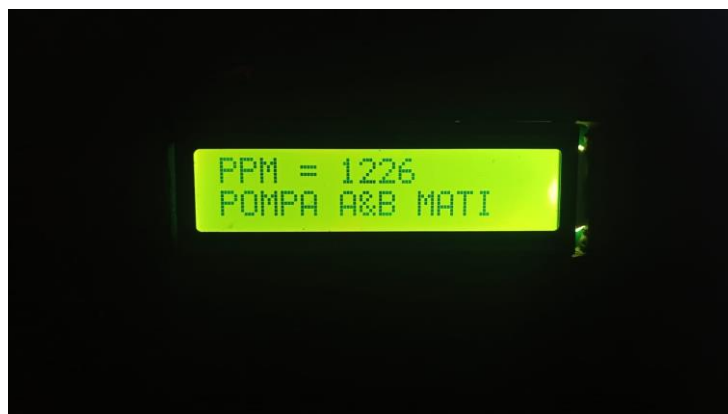
Gambar 45. pengujian keempat menggunakan EC sensor
