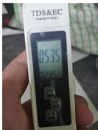
Gambar 38. pengujian pertama menggunakan TDS/EC meter
