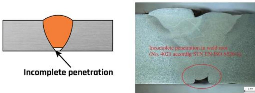
**Gambar 10.** *Incomplete penetration* muncul sebagai cacat ketika logam las tidak sepenuhnya menyatu dengan logam dasar di akar las, sehingga mengakibatkan diskontinuitas [50].
